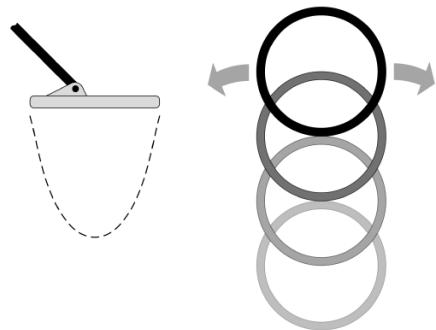
Помимо перекрывания предыдущего взмаха, важно держать катушку близко и параллельно к земле. При перемещении катушки по принципу маятника уменьшается глубина обнаружения. Кроме этого, если отстройка от влияния почвы отрегулирована не соответствующим образом, то изменение высоты между катушкой и землей может стать причиной возникновения откликов от грунта.
