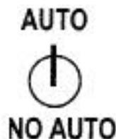
Этот тумблер может быть установлен в позиции: AUTO и NOAUTO. В положении AUTO пороговый тон детектора поддерживается на постоянном уровне независимо от небольших изменений в минерализации почвы. В положении NO-AUTO пороговый тон требует ручной настройки (путем нажатия кнопки PUSH BUTTON).
