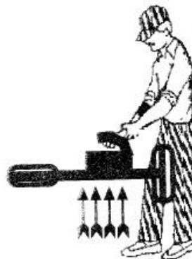
С) Не забывайте нажимать, удерживать секунду, а затем отпускать кнопку Push Button на рукоятке прибора каждый раз, когда делаете балансировку на грунт. При этом держите металлодетектор на расстоянии вытянутой руки, как чемодан.
